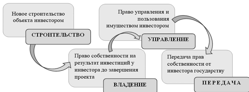
Рис. 1.8. Механизм ГЧП BOOT (Built, Own, Operate, Transfer — строительство — владение — управление — передача)
