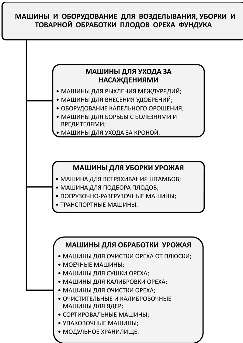
Рис.1. Комплекс машин и оборудования для возделывания, уборки и товарной обработки ореха фундука
